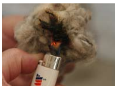
FLOC DE LLANA TRACTADA AMB IGNIFUGANT. NO FA FLAMA
